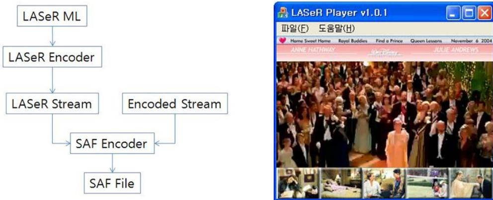
[그림 68] SAF 부호화 처리 흐름 및 LASer 플레이어 재생 화면
