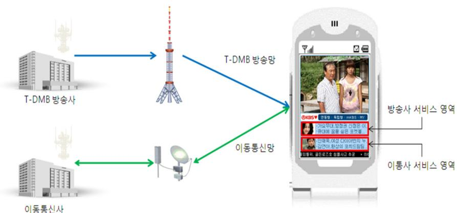
[그림 23] 방송망 및 통신망을 동시에 활용한 BIFS 제공 시스템 개념도
