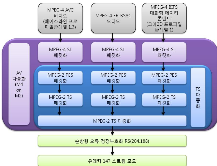
[그림 4] 지상파 DMB 비디오 서비스 전송 과정
