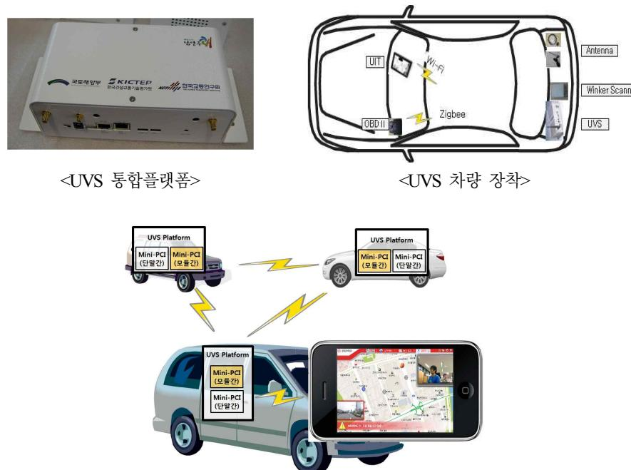
[그림 3-38] UIS(Ubiqitous Infrastructure Sensor) 통합 플랫폼 및 설치 사진
