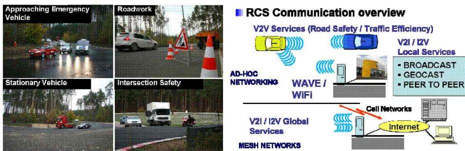
C2C-CC (car-to-car communication consortium) 프로젝트의 경우는 [그림 2-4]와 같이 IEEE 802.11p 차량간 통신 기술을 적용한 실시간 능동형 차량 안전 지원 시스템을 연구하고 있으며, Audi, BMW, Volkswagen, Renault, Fiat 등이 참여하고 있다.
