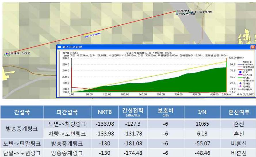
이러한 실험 결과를 종합하여 볼 때, 대전과 서울지역에서 방송 중계 송신소와 WAVE 기지국 또는 단말간 거리가 0.5~6km일 때의 WAVE 기지국과 단말의 출력신호가 방송 중계 링크의 간섭 영향은 없음을 알 수 있었다. 반면, 방송 중계 차량의 출력이 WAVE 통신 링크에 간섭 영향이 있으며, 두 장치간 떨어진 거리가 0.5~6 km 구간에서 모두 발생하는 결과를 얻을 수 있었다. 간섭 실험의 결과는 <표 5-4>에 요약되어 있다.
