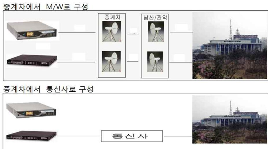
따라서 전체 링크의 구성은 [그림 5-6]에서 보이는 바와 같이 현장에서 중계용 카메라가 중계차량에 영상을 전송하게 되고 이를 중계차량이 송신탑으로 전송하게 된다. 이때 중계 헬기를 사용하기도 하지만 시뮬레이션에서는 고려치 않았다. 이렇게 중계된 영상은 최종적으로 방송국으로 송신된다.
