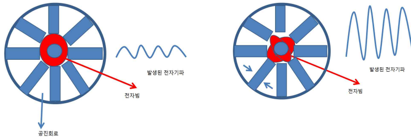
(a) 마그네트로 발진기 동작 전 (b) 마그네트론 발진기 동작 후 그림 3-4 마그네트론 발진기 동작 전후
