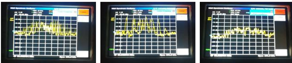
[그림 5-30] 수신레벨 34dB \mu V/m 주행속도 60km/h, 80km/h, 100km/h 시 스펙트럼
