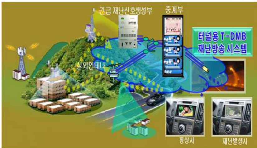
[그림 2-8] 터널용 DMB 재난방송시스템을 활용한 서비스 개념도
