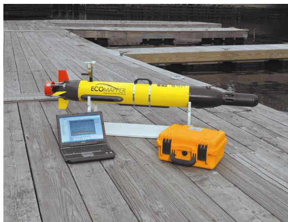
[Figure 25] YSI Hydrodata의 자동수중정보 측정장비 'EcpMapper'
