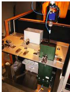
그림 4-3. 프로브 교정 시스템 및 VHF 대역의 인체노출량 평가시스템
